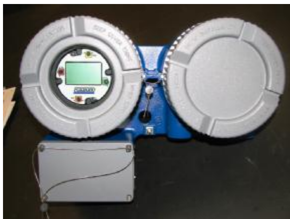
Рисунок 6 – Внешний вид пломбировки измерительного преобразователя CFT51 от несанкционированного доступа.
