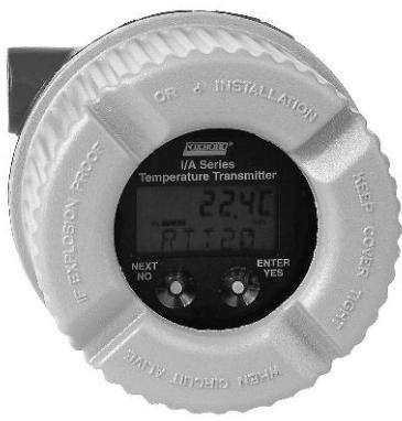
Преобразователи температуры I/A Series работают с термосопротивлениями (DIN, IEC или SAMA), различными термопарами, а также принимают омические и милливольтовые входы. Линеаризованный и изолированный выход может быть сконфигурирован как ток 4-20 мА, или 4-20 мА с протоколом HART, или 4-20 мА с протоколом FoxCom.
