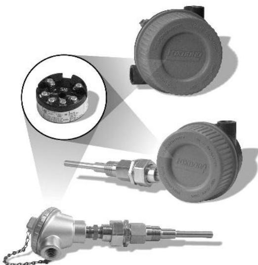
Преобразователи температуры I/A Series работают с термосопротивлениями и термопарами, а также принимают омические и милливольтовые входы. Линеаризованный и изолированный выход представляет собой ток 4-20 мА с протоколом HART, или цифровые протоколы Foundation Fieldbus или Profibus.
